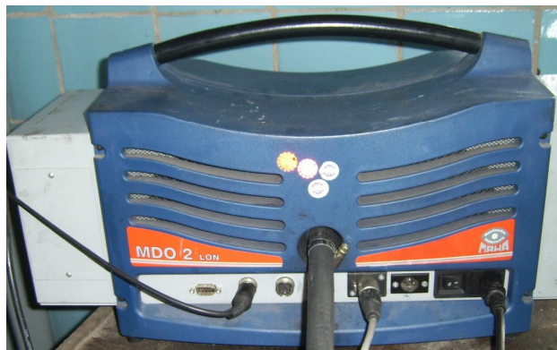
Рис. Д – Газоанализатор МАНА MGT-5 (а)(Германия), Дымомер МАНА MDO2 LON (б) (Германия)
