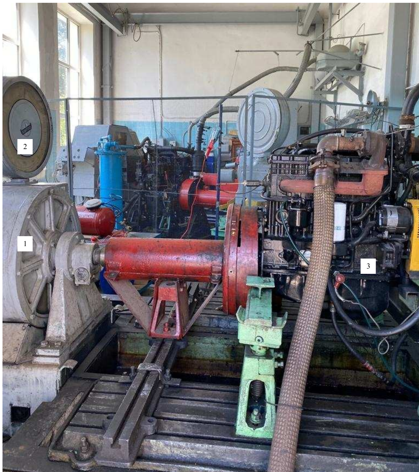
Рис. Б – Установка для проведения стендовых испытаний (Электротормозной стенд (1) SAK-N670 с балансирной маятниковой машиной (2) RAPIDO + дизель 4ЧН 11,0/12,5 (Д-245.5S2) (3))
