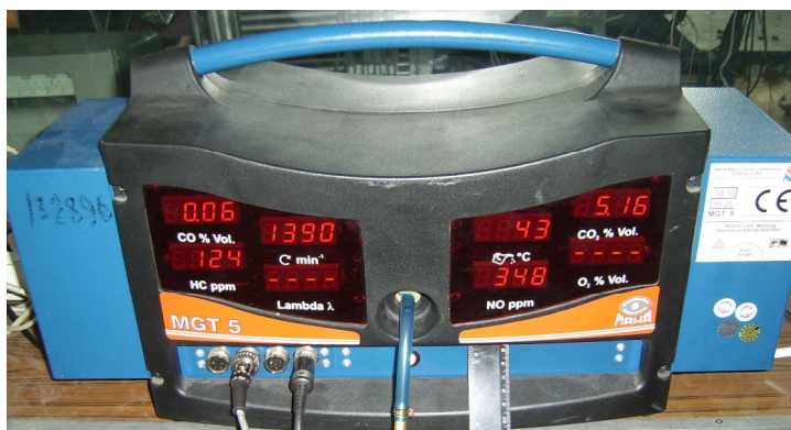
Рис. Д – Газоанализатор МАНА MGT-5 (а)(Германия), Дымомер МАНА MDO2 LON (б) (Германия)
